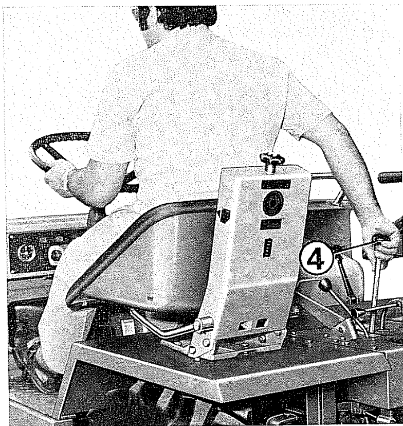
Fig. 3 - Inserimento del riduttore-invertitore
