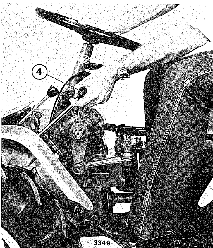
Fig. 6 - Inserimento del riduttore-invertitore.
