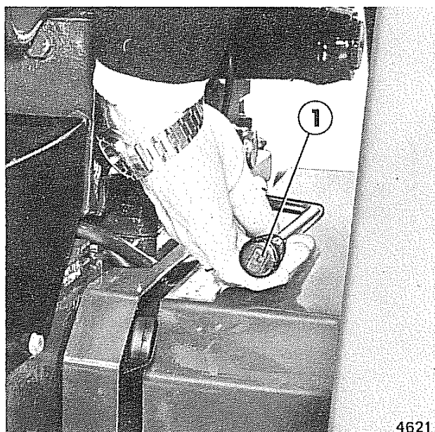
Fig. 8 - Innesto presa di forza indipendente
