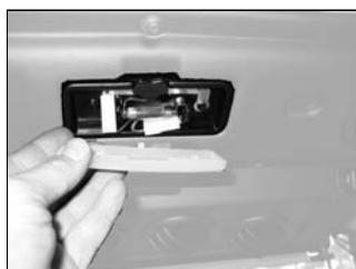
Togliere il vetrino della plafoniera facendo leva cautamente con un cacciavite, sostituire la lampadina, eseguire la prova di funzionamento e rimontare il vetrino.
