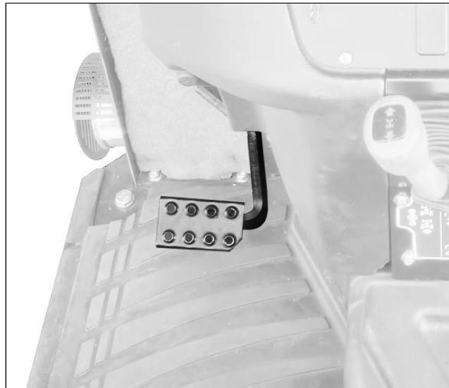
Collega il moto fra il motore e la trasmissione.
