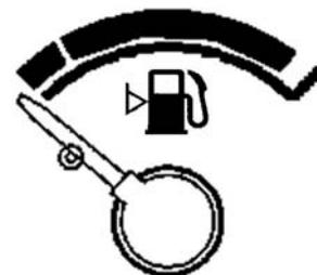
Il settore verde indica la quantità di carburante nel serbatoio. Quando l'indicatore si sposta nel settore rosso si ha l'accensione della spia gialla della riserva di carburante.
