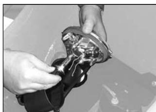
Sostituire le lampadine non funzionanti, con nuove di uguali caratteristiche tecniche (vedere indicazioni sulla lampadina stessa).
