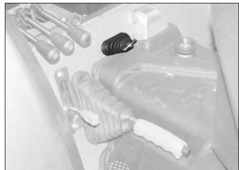
Wenn man die gleiche Stellvorrichtung angemessen lockert, erhält man eine größere Senkgeschwindigkeit des Krafthebers.
