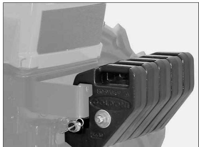
Wenn Geräte mit einem erheblichen Gewicht am Traktor angebaut werden, können diese die Standsicherheit desselben beeinträchtigen. Man kann die wahlweise erhältlichen Platten als Frontballast verwenden.
