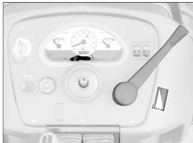
Der Handgaszug befindet sich vorn rechts im Traktor.
