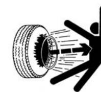
Die explosionsartige Abtrennung von Reifenstücken oder der Felge kann zu schweren oder tödlichen Verletzungen führen.
