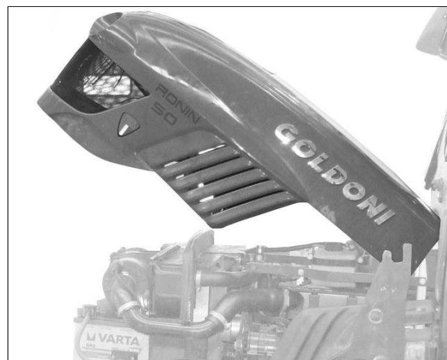
Wenn die Motorhaube geöffnet worden ist, bleibt sie dank einer Gasfeder in der erreichten Position
