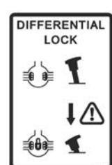
El tractor posee bloqueo diferencial trasero. Para la labor de arada o cuando una de las ruedas motrices pierde adherencia (terreno fangoso, accidentado, resbaladizo).
