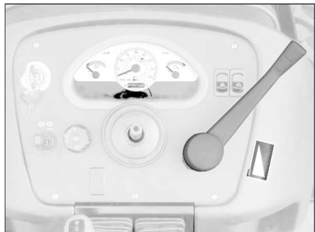
La palanca del acelerador de mano se halla en la zona delantera derecha del tractor. Aumentar y disminuir el número de revoluciones del tractor operando gradualmente con la palanca.
