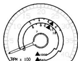
El número de revoluciones de la toma de fuerza se visualiza en las dos escalas graduadas dentro del instrumento, según la velocidad de rotación seleccionada.
