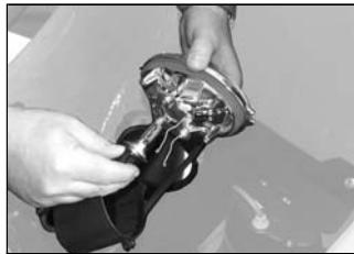
Substituir as lâmpadas que não funcionam, com novas de iguais características técnicas (ver indicações na própria lâmpada).
