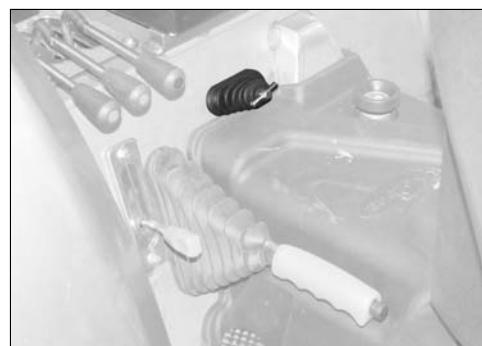
Desenroscando oportunamente o mesmo registo, obtém-se uma maior velocidade de descida do levantador.
