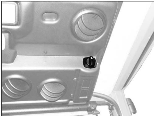
Com o botão é possível regular a temperatura do ar frio. Rodando o botão regula-se a temperatura. Rodando no sentido horário (totalmente para a direita), obtém-se o arrefecimento máximo no interior da cabina. Rodando no sentido anti-horário (totalmente para a esquerda), interrompe-se a circulação de ar frio na cabina.
