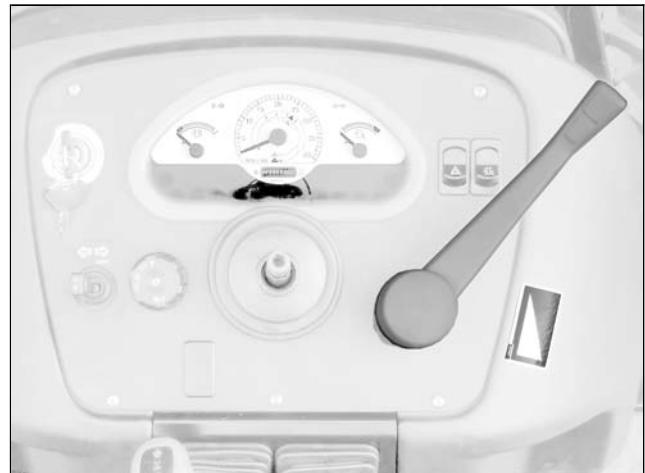
A alavanca do acelerador de mão situa-se na zona dianteira direita da máquina. Aumentar e diminuir o número de rotações da máquina accionando a alavanca gradualmente.
