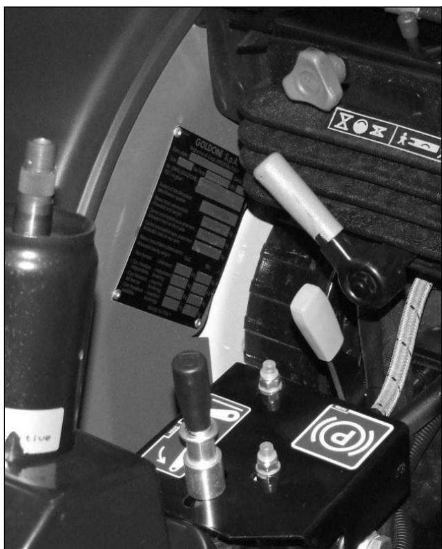
La plaque en métal est placée à l'intérieur du garde-boue arrière droite.
