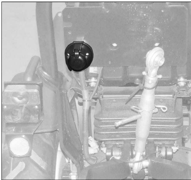
La prise à 7 contacts permet de brancher des feux indicateurs de direction et d'autres dispositifs électriques d'une remorque ou d'un équipement.
