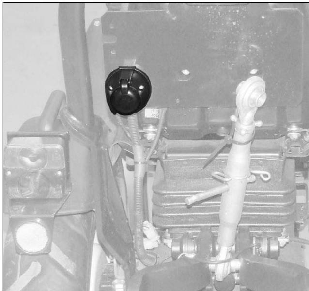
La toma de 7 contactos permite conectar luces, luces de dirección y otros dispositivos eléctricos para un remolque o un implemento.
