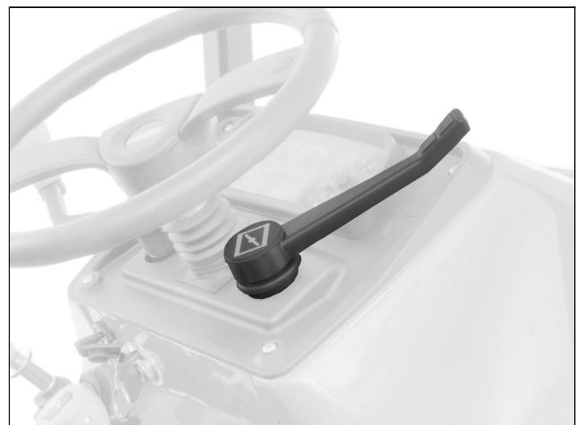
La leva dell'acceleratore a mano si trova nella zona anteriore destra della macchina. Aumentare e diminuire il numero di giri della macchina agendo sulla leva gradualmente.
