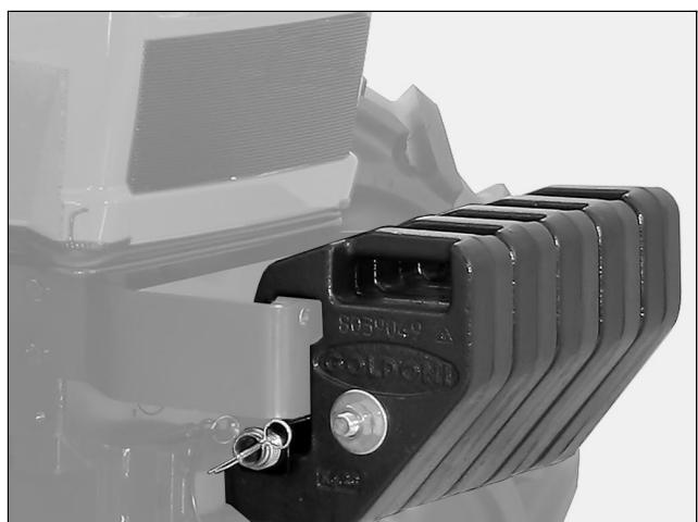
Se alla macchina vengono applicati attrezzi di peso rilevante che possono compromettere la stabilità, è possibile usare come zavorre anteriori le apposite piastre opzionali.
