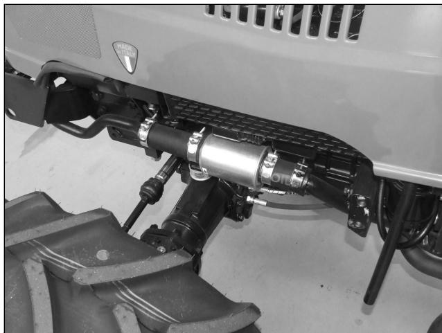
Sostituire il filtro esterno, all'occorrenza o al massimo ogni 300 h.
