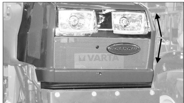
Il cofano motore, una volta aperto rimane in posizione grazie ad una molla a gas. Per chiudere il cofano motore, abbassarlo fino al completo aggancio della serratura.
