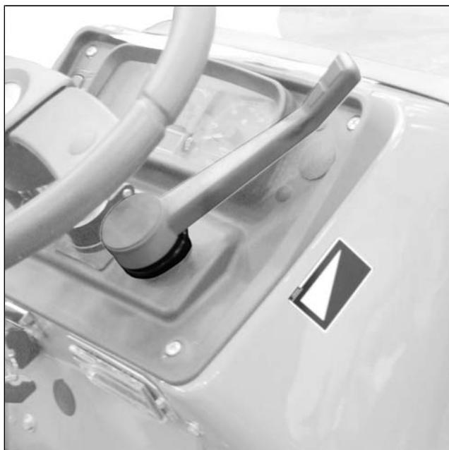
La leva dell'acceleratore a mano si trova nella zona anteriore destra della macchina.
