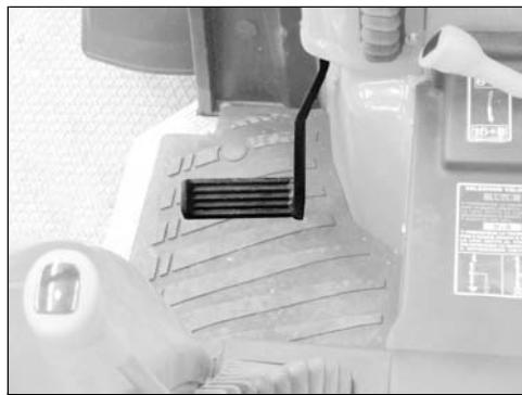
Collega il moto fra il motore e la trasmissione.
