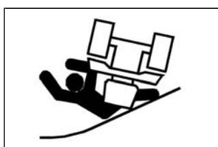
I pendii sono un fattore importante per gli incidenti causati da perdita di controllo e ribaltamento, che possono causare gravi lesioni, anche mortali. Tutte le operazioni su terreni in pendenza richiedono una particolare cautela.
