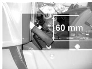
Periodicamente controllare la corsa a vuoto del comando.
