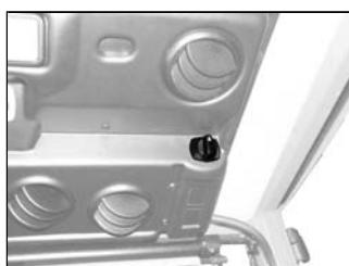
Con la manopola è possibile regolare la temperatura dell'aria fredda. Ruotando la manopola si regola la temperatura, ruotando in senso orario (tutto a destra) si ottiene il massimo del raffreddamento all'interno della cabina.
