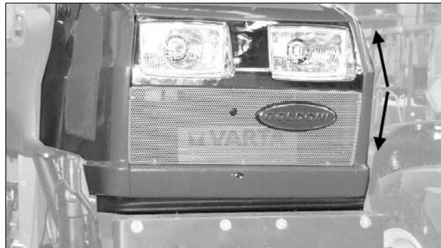
El capó motor, una vez abierto permanece en esa posición gracias a un resorte de gas. Para cerrar el capó motor, bajarlo hasta el enganche completo de la cerradura
