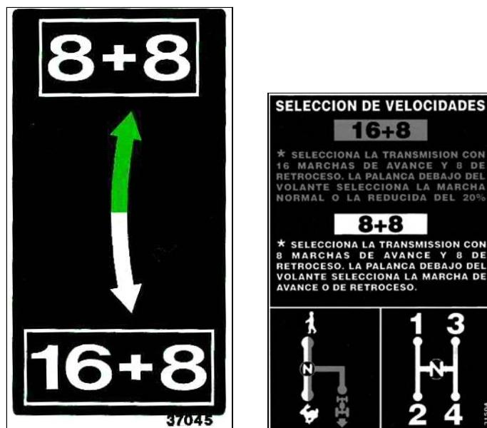
El tractor cuenta con una transmisión **Dual Power** que permite obtener 2 diferentes modalidades de cambio, seleccionando la palanca MODO CAMBIO.
