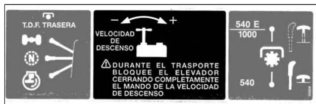
Desenroscando oportunamente dicha regulación se logra una mayor velocidad de descenso del elevador.
