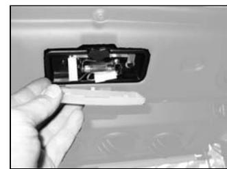
Quitar el vidrio del plafón haciendo palanca con cuidado con un destornillador, sustituir la bombilla, efectuar la prueba de funcionamiento y volver a montar el vidrio.
