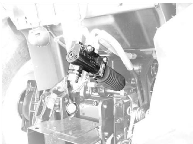
La válvula de frenado remolque se engancha acoplando la válvula hidráulica hembra del remolque en el acoplamiento macho. Antes de enganchar la válvula quitar la protección de goma
