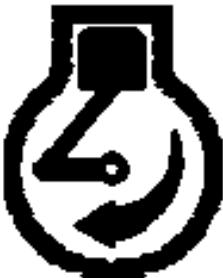
Es independiente de las velocidades de avance del tractor y se puede accionar con la máquina parada o en movimiento.
