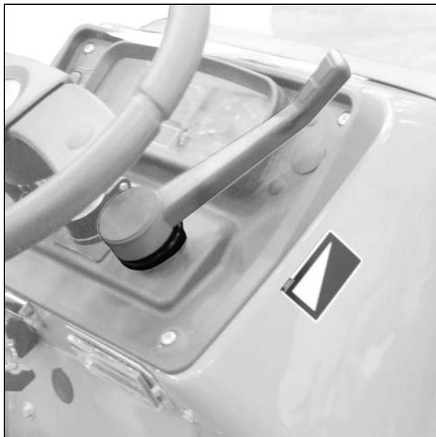
La palanca del acelerador de mano se halla en la zona delantera derecha del tractor. Aumentar y disminuir el número de revoluciones del tractor operando gradualmente con la palanca.
