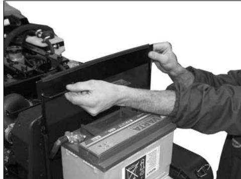
Das Kühlerschutzgitter bei Bedarf oder mindestens einmal pro Woche reinigen:
