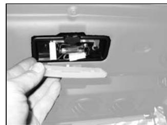
Das Glas der Deckenlampe herausnehmen, indem man es vorsichtig mit einem Schraubenzieher abhebt. Die Lampe ersetzen, prüfen, ob das Licht brennt, und das Glas wieder montieren.
