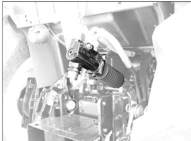
Das Anhängerbremsventil wird angeschlossen, indem man das Hydraulikventil mit Innengewinde des Anhängers an die Hydrauliksteckbuchse mit Außengewinde anschließt.
