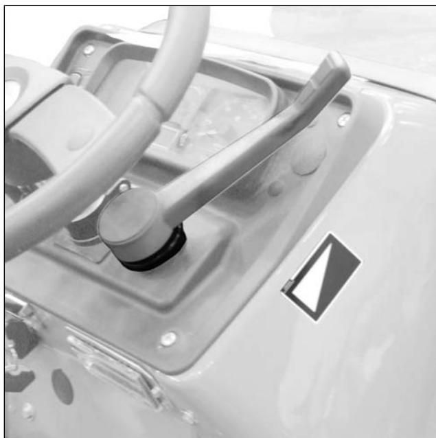
Der Handgaszug befindet sich vorn rechts im Traktor.
