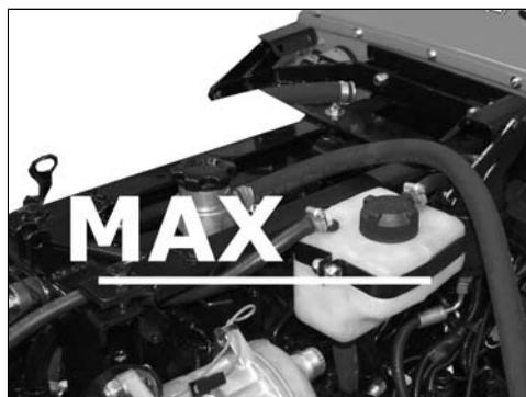
Bei Bedarf ist Kühlflüssigkeit nachzufüllen, um den Stand zu korrigieren:
