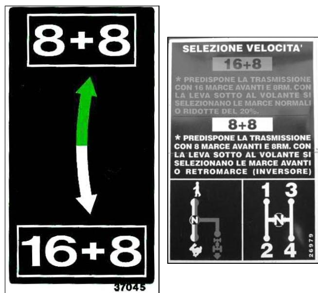
La macchina dispone di una trasmissione **Dual Power** che permette di ottenere 2 differenti modalità di cambio selezionando la leva MODO CAMBIO.
