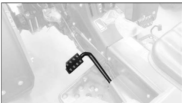
Collega il moto fra il motore e la trasmissione.
