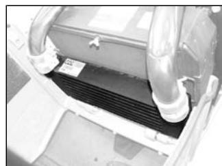
Pulire la protezione del radiatore all'occorrenza o al massimo una volta a settimana:
