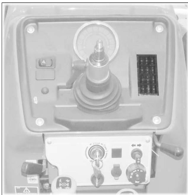
L'impianto elettrico è protetto da un eventuale corto circuito o da un anomalo assorbimento di corrente, da valvole fusibili.
