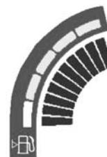
Il settore verde indica la quantità di carburante nel serbatoio. Quando gli indicatori si illuminano nel settore rosso si ha l'accensione della spia gialla della riserva di carburante.
