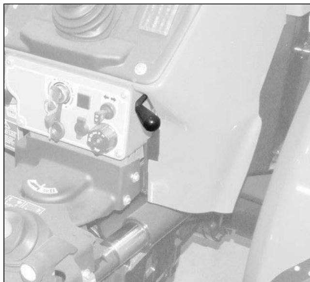
La leva dell'acceleratore a mano si trova nella zona anteriore destra della macchina.
