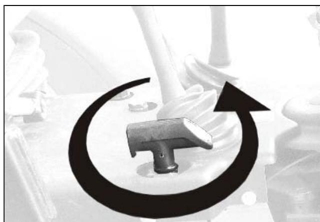
Per disinserire il freno di stazionamento:
