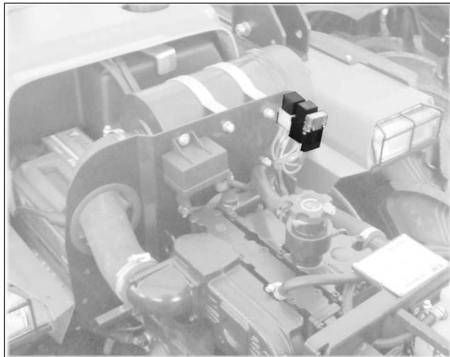
La máquina está equipada con **fusibles generales**. Estos fusibles protegen toda la instalación eléctrica.
