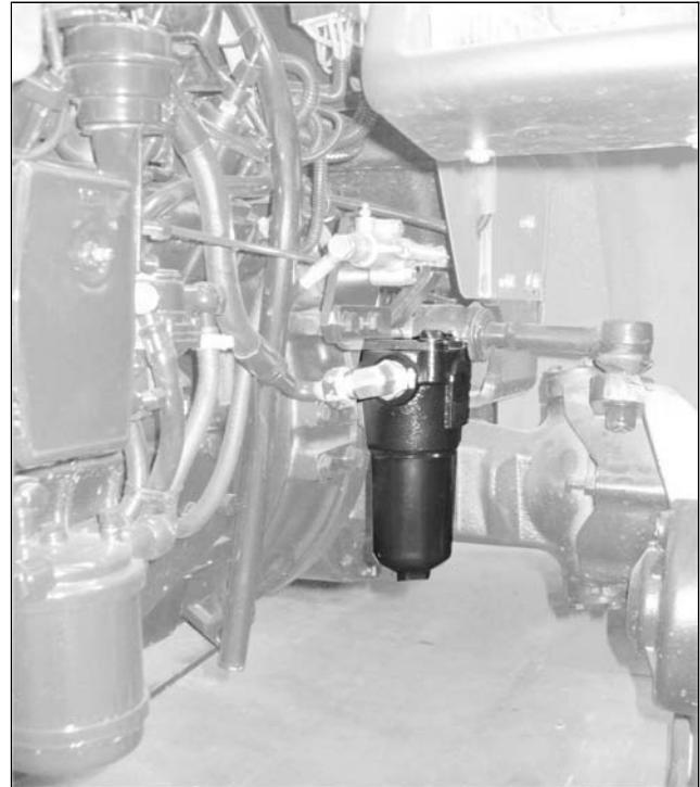
Den internem Einsatz des Getriebeölfilters in der Druckleitung ersetzen:
