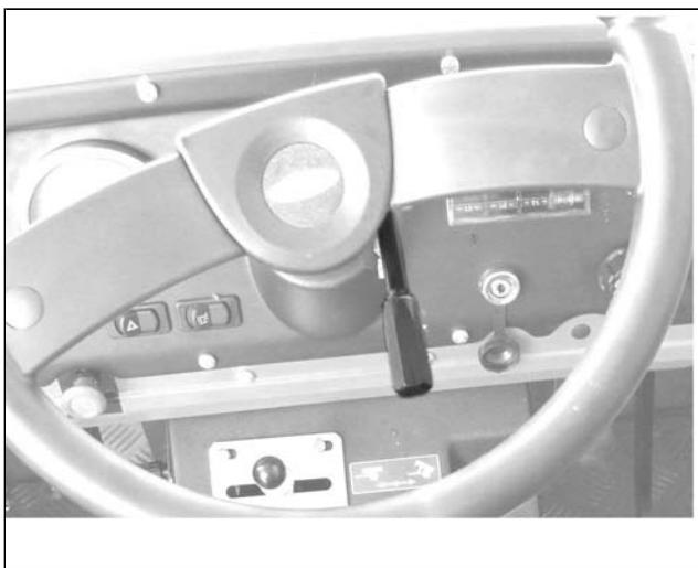
La leva dell'acceleratore a mano si trova nella zona anteriore destra della macchina.
