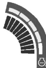
La soglia di eccessiva temperatura del liquido di raffreddamento motore è indicata tramite:
