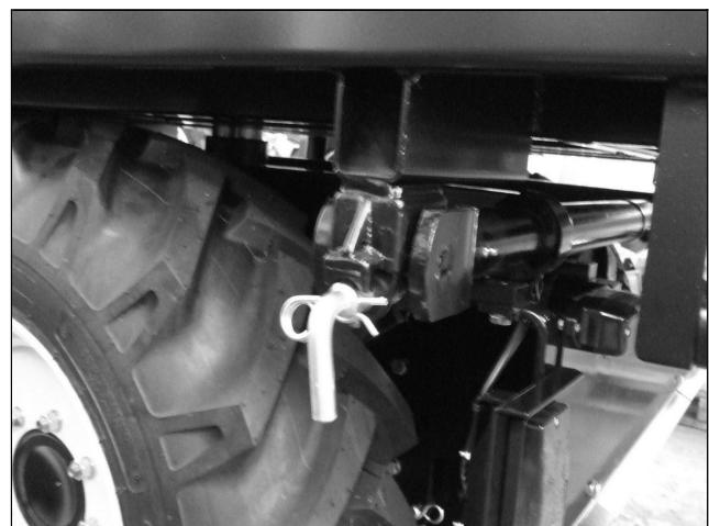
Snodo sferico con perno di sicurezza e spinotto di sicurezza inseriti
