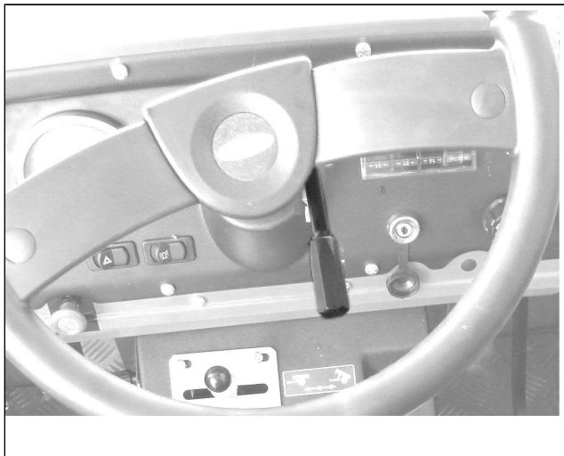
La leva dell'acceleratore a mano si trova nella zona anteriore destra della macchina. Aumentare e diminuire il numero di giri della macchina agendo sulla leva gradualmente.
