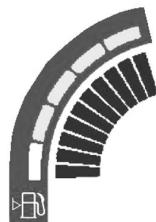
Il settore verde indica la quantità di carburante nel serbatoio. Quando gli indicatori si illuminano nel settore rosso si ha l'accensione della spia gialla della riserva di carburante.
