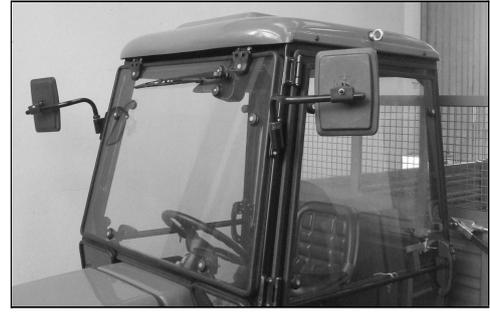
Espejos retrovisores externos oscilante para una visión óptima desde el puesto de conducción.
