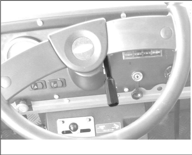
La palanca del acelerador de mano se halla en la zona delantera derecha del tractor. Aumentar y disminuir el número de revoluciones del tractor operando gradualmente con la palanca.
