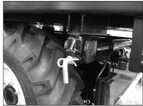
Articulación esférica con perno de seguridad y pasador de seguridad insertados
