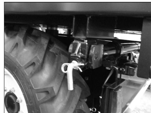
Kugelgelenk mit steckenden Sicherungsbolzen und Sicherungssplinten
