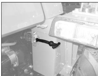
Die zughaken ausrasten lassen und die Motorhaube heben.
