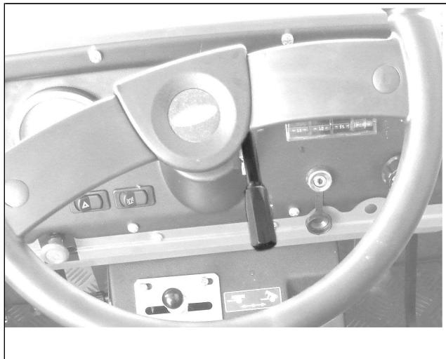
Der Handgaszug befindet sich vorn rechts im Traktor.
