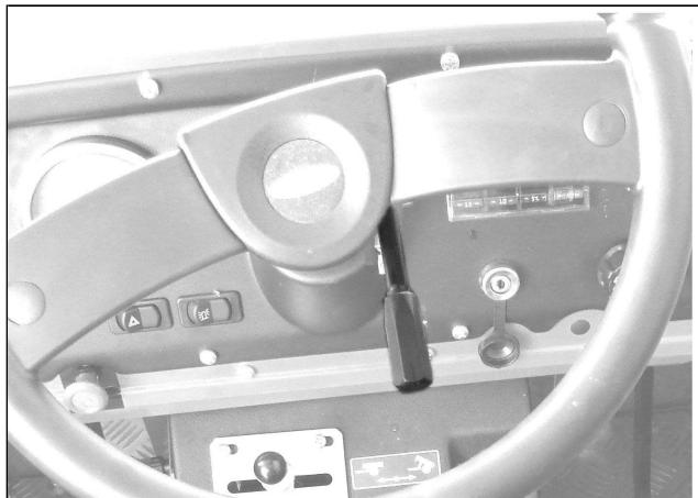
A alavanca do acelerador de mão situa-se na zona dianteira direita da máquina. Aumentar e diminuir o número de rotações da máquina accionando a alavanca gradualmente.
