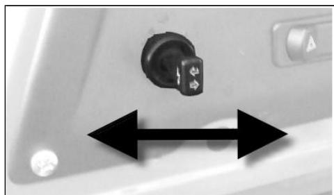
Pour indiquer le changement de direction vers la droite, déplacer l'interrupteur à droite.
