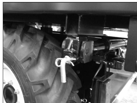
Articulation sphérique avec axe de sécurité et goujon de sécurité insérés.
