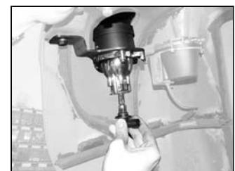
Remplacer les ampoules brûlées par des neuves ayant les mêmes caractéristiques (voir les indications sur l'ampoule).
