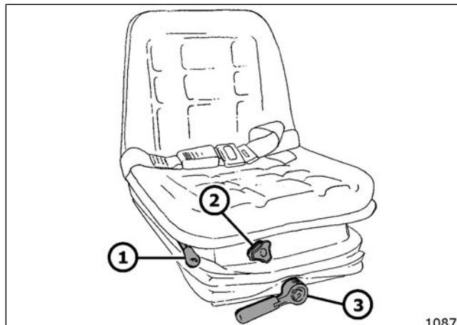
① Réglage longitudinal du siège.
