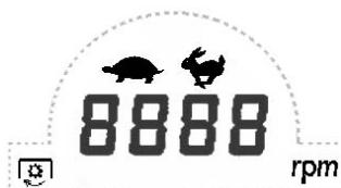
Appuyer sur le bouton extérieur pour changer l'afficheur. Le nombre de tours est visualisé dans la partie centrale de l'afficheur.
