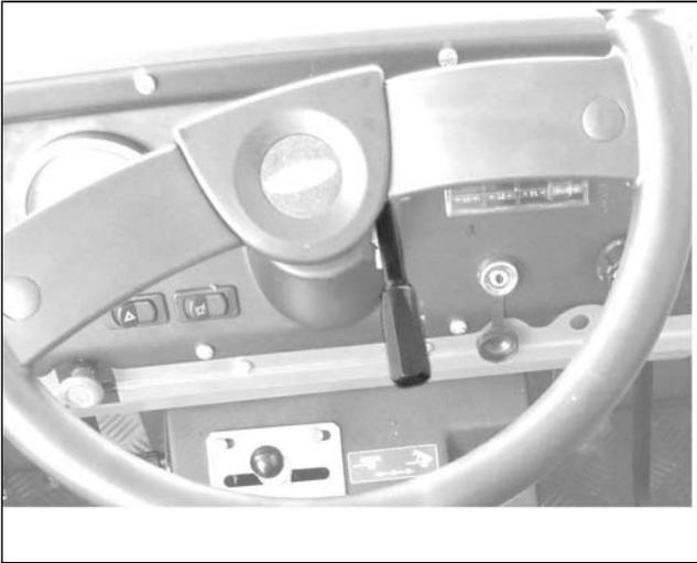
Der Handgaszug befindet sich vorn rechts im Traktor. Die Motordrehzahl des Traktors erhöhen oder verringern, indem man den Handgaszug allmählich betätigt.
