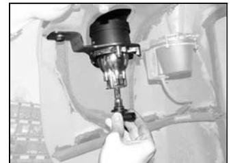
Die durchgebrannten Glühlampen sind durch neue mit den gleichen technischen Eigenschaften zu ersetzen (siehe die Angaben auf der Glühlampe selbst).
