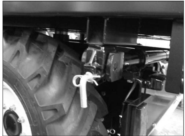
Kugelgelenk mit steckenden Sicherungsbolzen und Sicherungssplinten
