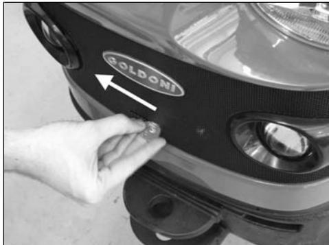
Use a chave de ignição e deslize-o para a esquerda até a liberação do bloqueio
