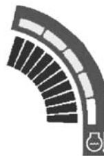
O limite de excessiva temperatura do líquido de arrefecimento motor está indicado através:
