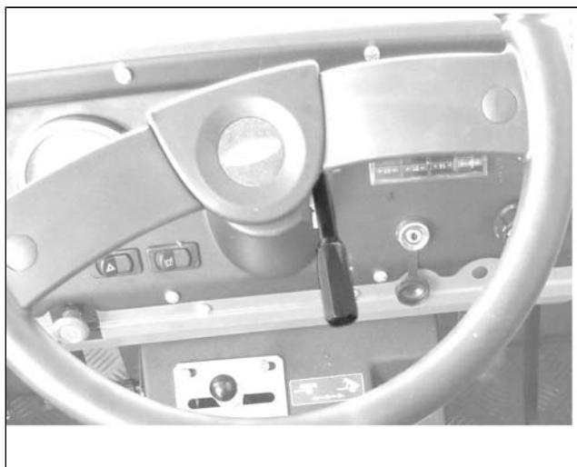
A alavanca do acelerador de mão situa-se na zona dianteira direita da máquina.
