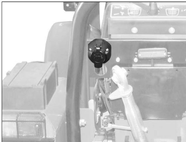
La prise à 7 contacts permet de brancher des feux indicateurs de direction et d'autres dispositifs électriques d'une remorque ou d'un équipement.
