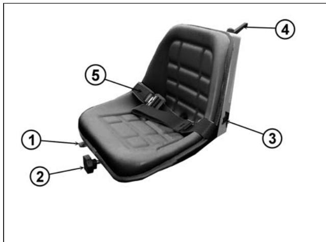
① Réglage longitudinal du siège.
