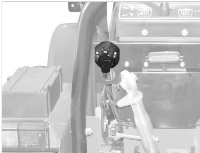
Die Sieben-polige Steckdose dient zum Anschluss der Beleuchtung, der Fahrrichtungsanzeiger, anderer elektrischer Vorrichtungen für einen Anhänger oder ein Gerät.
