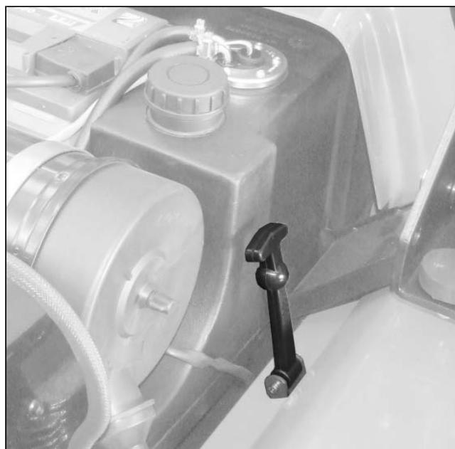
Die zughaken ausrasten lassen und die Motorhaube heben.
