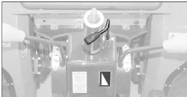
La palanca del acelerador de mano se halla en la zona delantera derecha del tractor.
