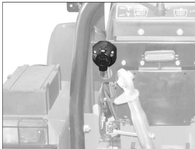
La toma de 7 contactos permite conectar luces, luces de dirección y otros dispositivos eléctricos para un remolque o un implemento.
