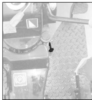
A alavanca do acelerador de mão situa-se na zona dianteira direita da máquina.
