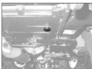
Controllare il livello dell'olio tramite il tappo con asta graduata situato in prossimità del freno di stazionamento. Il livello deve essere al minimo con il tappo solo appoggiato, oppure, tra il minimo e il massimo con il tappo avvitato.
