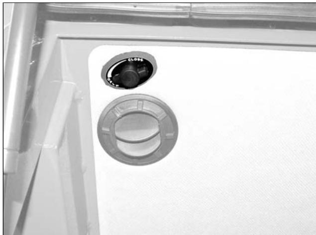
Con la manopola è possibile regolare la temperatura dell'aria calda. Ruotando la manopola si regola la temperatura, ruotando in senso orario (tutto a destra) si ottiene il massimo del riscaldamento all'interno della cabina. Ruotando (tutto a sinistra) si interrompe la circolazione di aria calda nella cabina.
