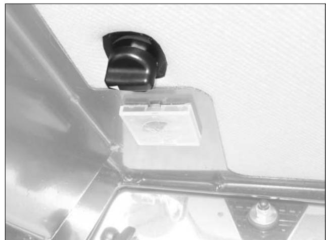
Con la manopola è possibile regolare la temperatura dell'aria fredda. Ruotando la manopola si regola la temperatura, ruotando in senso orario (tutto a destra) si ottiene il massimo del raffreddamento all'interno della cabina. Ruotando (tutto a sinistra) si interrompe la circolazione di aria fredda nella cabina.
