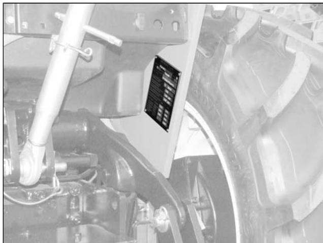
Die metallplatte ist in der rechten hinteren Kotflügel befindet
