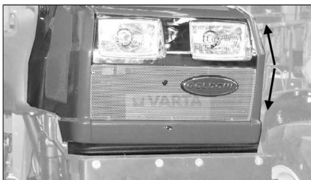
Wenn die Motorhaube geöffnet worden ist, bleibt sie dank einer Gasfeder in der erreichten Position
