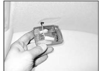
Das Glas der Deckenlampe herausnehmen, indem man es vorsichtig mit einem Schraubenzieher abhebt. Die Lampe ersetzen, prüfen, ob das Licht brennt, und das Glas wieder montieren.
