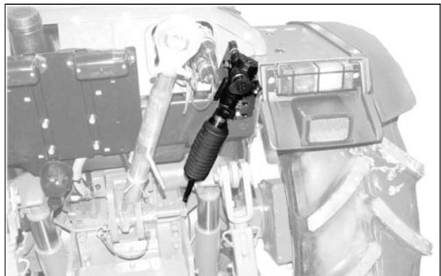
Das Anhängerbremsventil wird angeschlossen, indem man das Hydraulikventil mit Innengewinde des Anhängers an die Hydrauliksteckbuchse mit Außengewinde anschließt. Vor dem Anschluss des Ventils die Gummischutzkappe entfernen.
