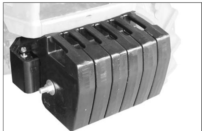
Wenn Geräte mit einem erheblichen Gewicht am Traktor angebaut werden, können diese die Standsicherheit desselben beeinträchtigen. Man kann die wahlweise erhältlichen Platten als Frontballast verwenden.
