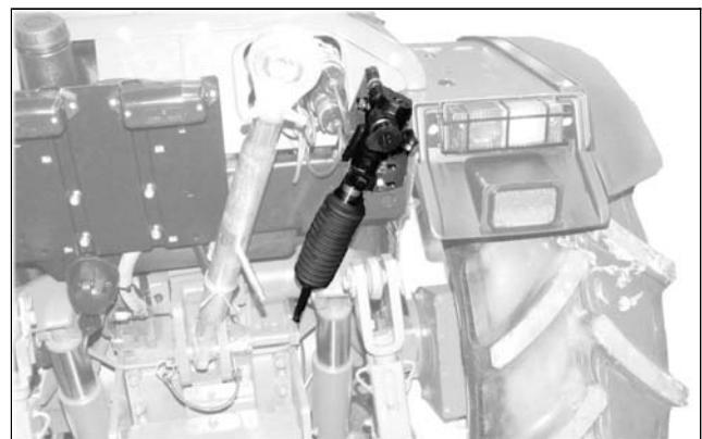
La válvula de frenado remolque se engancha acoplando la válvula hidráulica hembra del remolque en el acoplamiento macho.
