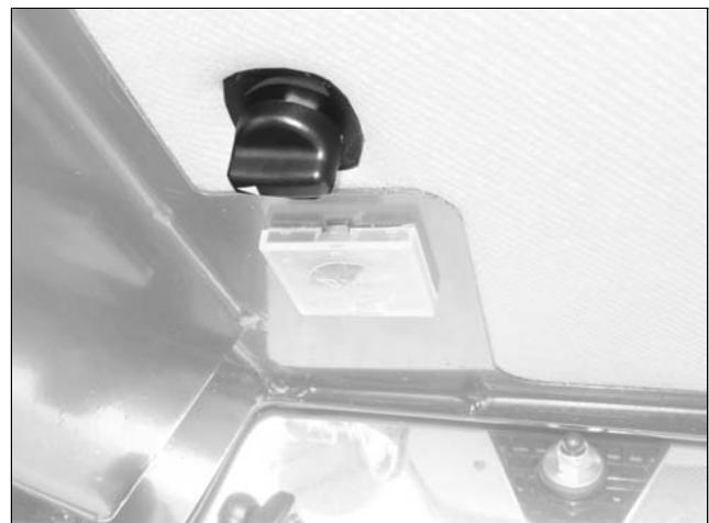
Con el mando es posible regular la temperatura del aire frío. Girando el mando se regula la temperatura, girándolo en sentido horario (todo hacia la derecha) se logra la máxima refrigeración dentro de la cabina.
