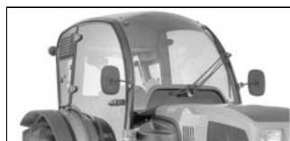
Espejos retrovisores exteriores oscilante para una vision optimal desde el puesto de conducción.
