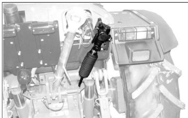
A válvula de travagem do reboque é fixada encaixando a válvula hidráulica fêmea do reboque na tomada macho. Antes de fixar a válvula, tire a protecção de borracha
