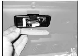
Tire o vidro do plafonier exercendo com cuidado a acção de alavanca com uma chave de parafusos. Substitua a lâmpada, execute o teste de funcionamento e reinstale o vidro.
