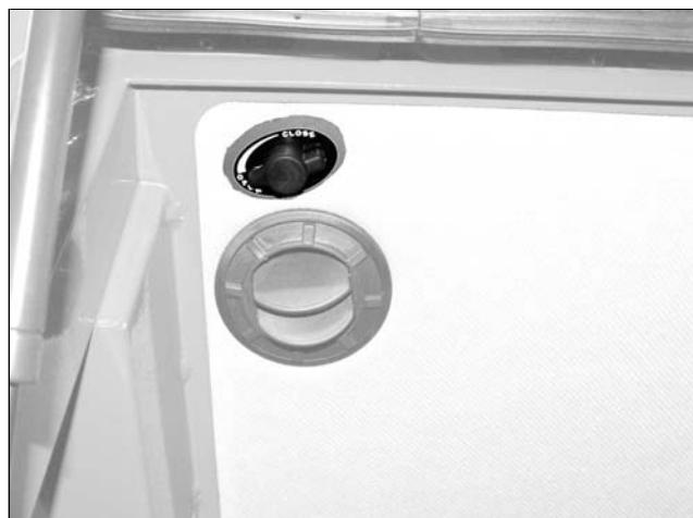
Com o botão é possível regular a temperatura do ar quente. Rodando o botão regula-se a temperatura. Rodando no sentido horário (totalmente para a direita), obtém-se o aquecimento máximo no interior da cabina. Rodando no sentido anti-horário (totalmente para a esquerda), interrompe-se a circulação de ar quente na cabina.
