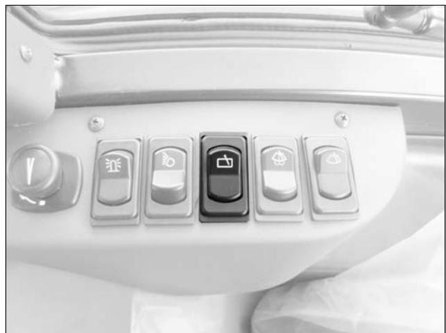
Funciona com a chave de ignição na posição de contacto. Para accionar o limpa-vidros traseiro, carregue no interruptor na posição um.
