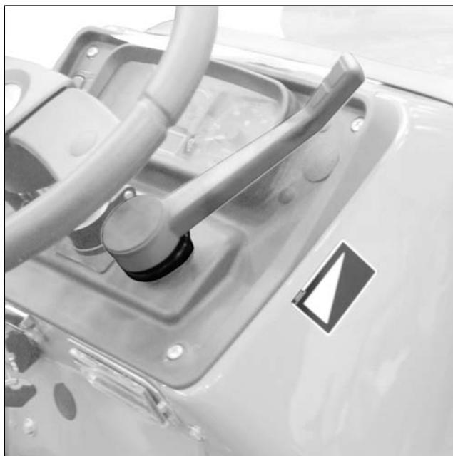
A alavanca do acelerador de mão situa-se na zona dianteira direita da máquina.
