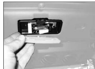
Das Glas der Deckenlampe herausnehmen, indem man es vorsichtig mit einem Schraubenzieher abhebelt. Die Lampe ersetzen, prüfen, ob das Licht brennt, und das Glas wieder montieren.
