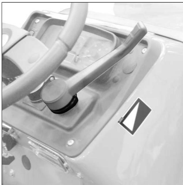
Der Handgaszug befindet sich vorn rechts im Traktor. Die Motordrehzahl des Traktors erhöhen oder verringern, indem man den Handgaszug allmählich betätigt.
