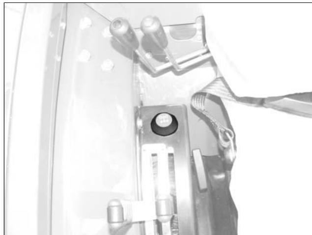
Der Traktor ist mit einer hinteren Differentialsperre versehen.
