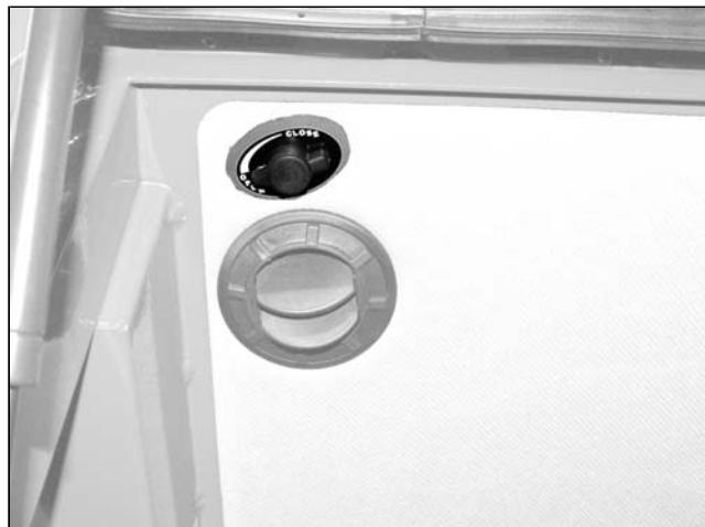
Mit dem Drehschalter kann man die Temperatur der warmen Luft einstellen. Dreht man den Drehschalter, regelt man die Temperatur. Beim Drehen im Uhrzeigersinn (ganz nach rechts) erhält man die maximale Heizung der Luft in der Kabine.
