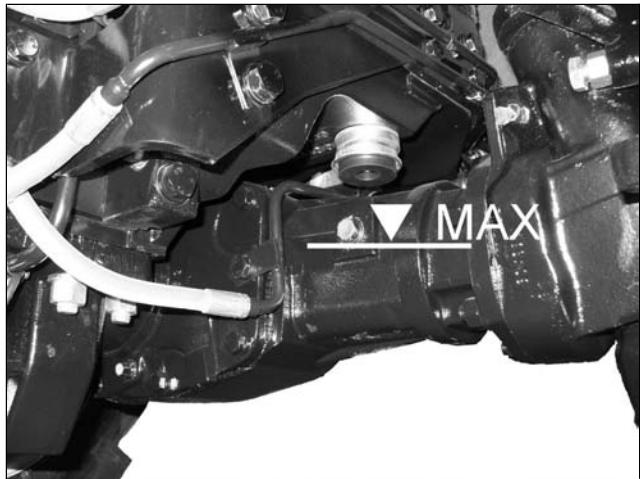
Den Ölstand mit dem Standprüfstopfen prüfen. Das Öl muss bis zur unteren Lochkante stehen.
