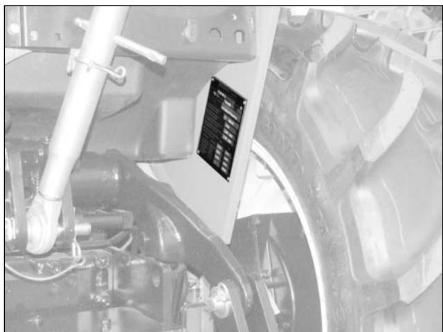
La plaque en métal est placée à l'intérieur du garde-boue arrière droite.
