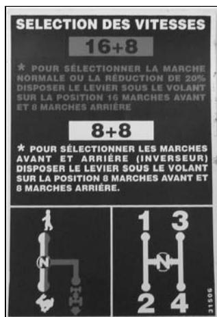
La machine dispose d'une transmission **Dual Power** qui permet d'obtenir 2 modes différents de changement de vitesses en sélectionnant le levier MODE VITESSE.
