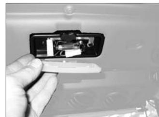
Enlever le verre du plafonnier en faisant prudemment levier avec un tournevis, remplacer l'ampoule, faire un essai de fonctionnement et remonter le verre.
