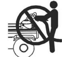
Pour éviter les blessures aux personnes ou les dégâts aux biens, manipuler le carburant avec précaution. Le carburant est extrêmement inflammable et ses vapeurs sont explosives.
