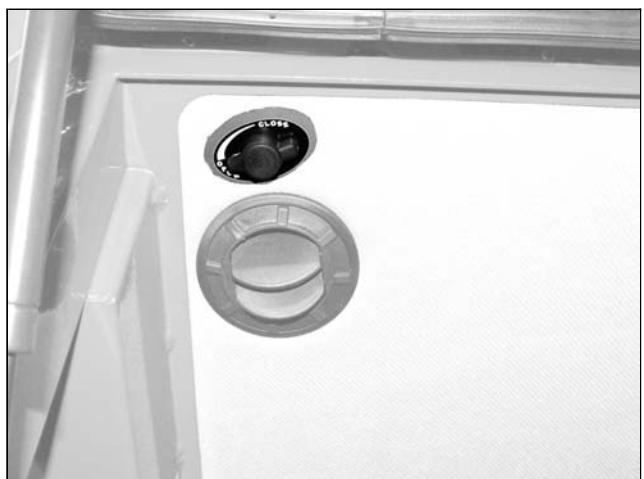
Avec la manette il est possible de régler la température de l'air chaud. Tourner la manette pour régler la température, dans le sens horaire (tout à droite) on obtient le chauffage maximum à l'intérieur de la cabine.
