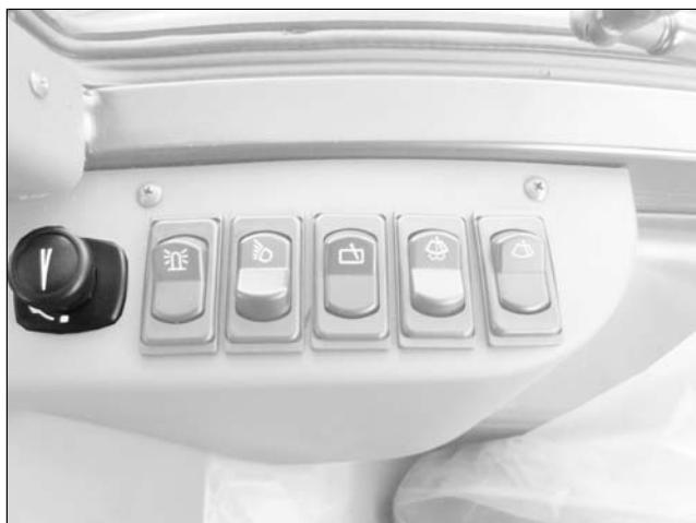
Pour modifier la quantité d'air insufflée dans la cabine agir sur les trois vitesses de l'électroventilateur.
