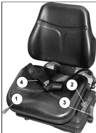
**1** Réglage longitudinal du siège.
