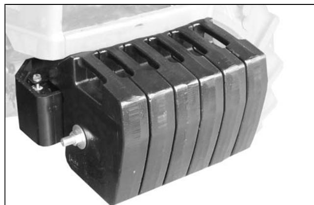
Si des outils particulièrement lourds pouvant compromettre la stabilité sont attelés à la machine, il est possible d'utiliser les plaques en option comme masses de lestage avant.
