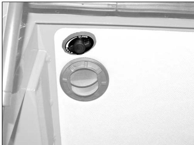
Con el mando es posible regular la temperatura de calefaccion. Girando el mando se regula la temperatura, girándolo en sentido horario (todo hacia la derecha) se logra la máxima calefaccion dentro de la cabina. Girándolo (todo hacia la izquierda) se interrumpe la circulación del aire caliente en la cabina.
