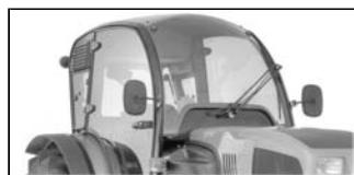
Espejos retrovisores exteriores oscilante para una vision óptima desde el puesto de conducción.
