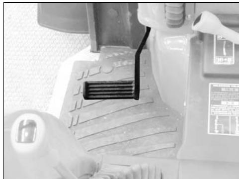
Acopla el movimiento entre el motor y la transmisión.
