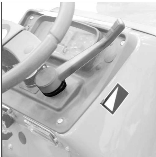
La palanca del acelerador de mano se halla en la zona delantera derecha del tractor.
