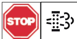
Le couple du moteur est limité. La régénération automatique est interdite. L'opérateur doit, au plus tôt, lancer manuellement la régénération de service.
