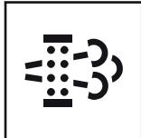
L'opérateur doit désactiver l'inhibition de la régénération afin de permettre le démarrage de la régénération automatique. La demande de lancement de la régénération automatique est effectuée ; si la régénération démarre, l'indicateur s'allume :
