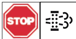
Le couple du moteur est réduit de 50%. La régénération automatique est déshabilitee. L'opérateur doit, le plus tôt possible, lancer manuellement la régénération de service.
