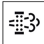
L'opérateur doit désactiver l'inhibition de la régénération afin de permettre le démarrage de la régénération automatique. La demande de lancement de la régénération automatique est effectuée ; si la régénération démarre, l'indicateur s'allume :
