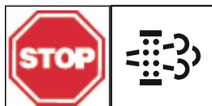
Le couple du moteur est réduit de 25%. La régénération automatique est déshabilitee. L'opérateur doit, le plus tôt possible, lancer manuellement la régénération de service.
