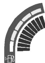
绿色部分表示油箱中的燃油量。在红色区域内指示灯亮起时，黄色燃油存量指示灯亮起。
