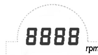
发动机转速通过显示屏上的 4 个中央数据显示。
