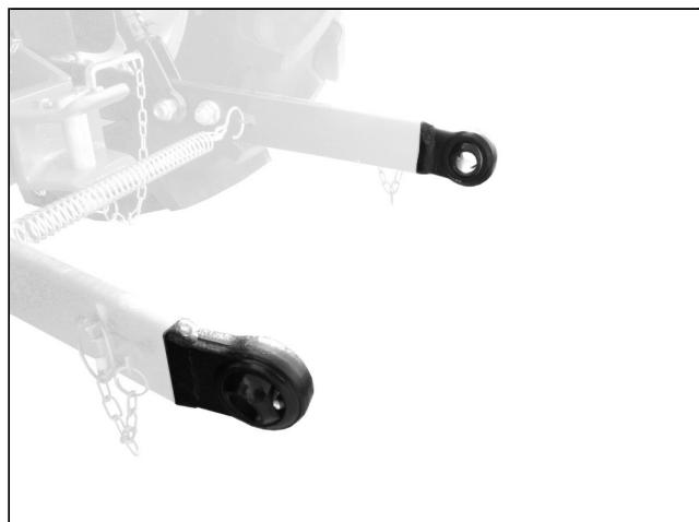
下链接端球配有两个孔，用于 1 类和 2 类设备。
