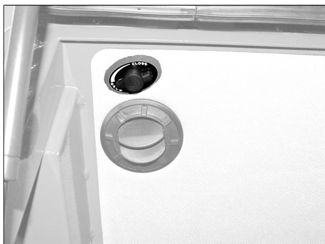
С помощью ручки можно регулировать температуру горячего воздуха. Вращая ручку, можно отрегулировать температуру. Вращая ее в направлении по часовой стрелке (вправо до упора) можно обеспечить максимальный обогрев внутренней части кабины.
