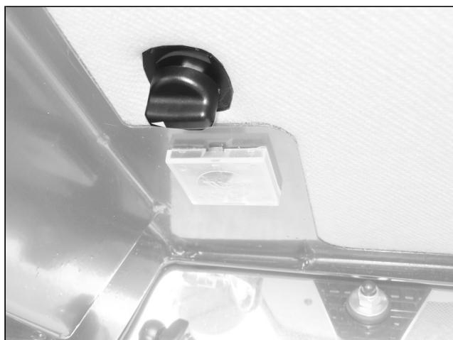
С помощью ручки можно регулировать температуру холодного воздуха. Вращая ручку, можно отрегулировать температуру. Вращая ее в направлении по часовой стрелке (вправо до упора) можно обеспечить максимальное охлаждение внутренней части кабины.
