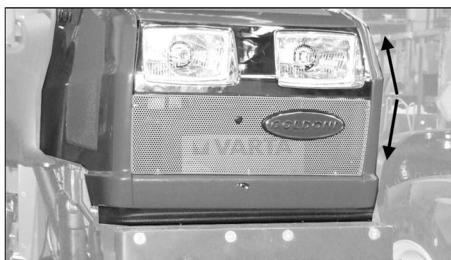
Капот остается в открытом положении благодаря газовой пружине.
