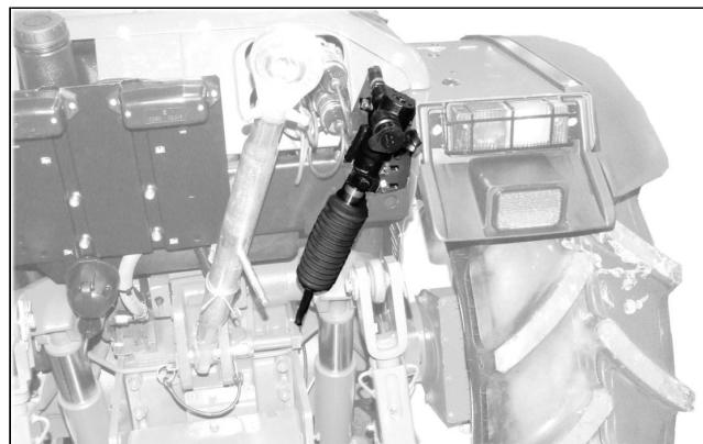
Клапан торможения прицепа зацепляется, активируя гидравлический клапан прицепа в охватываемом разъеме.
