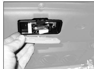
Осторожно снимите стеклянный рассеиватель с помощью отвертки, замените лампу, проверьте ее работу и установите рассеиватель.
