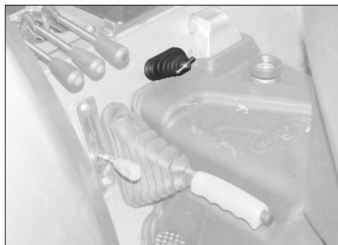
Ослабляя фиксатор, можно увеличивать скорость опускания подъемника.
