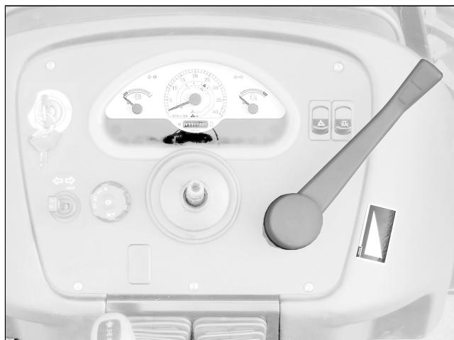
Рычаг ручного акселератора расположен в правой передней части машины. Увеличите или уменьшите число оборотов машины, плавно перемещая рычаг.
