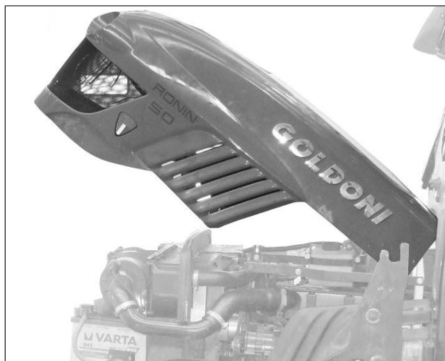
Капот остается в открытом положении благодаря газовой пружине.
