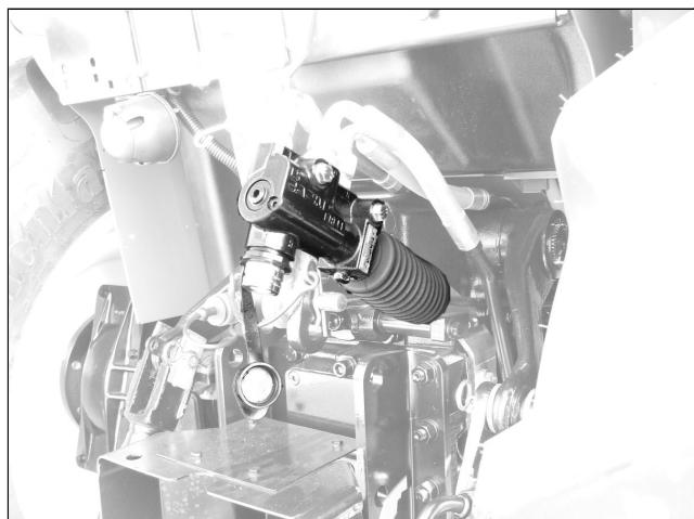
Клапан торможения прицепа зацепляется, активируя гидравлический клапан прицепа в охватываемом разъеме.
