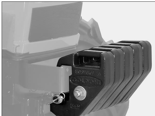
Если на машину устанавливаются орудия значительного веса, которые могут повлиять на ее устойчивость, можно использовать в качестве передних противовесов дополнительные пластины.
