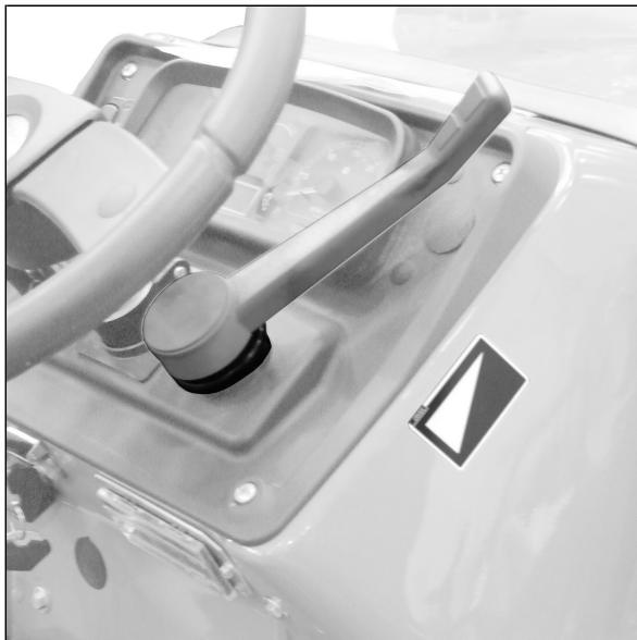
Рычаг ручного акселератора расположен в правой передней части машины.
