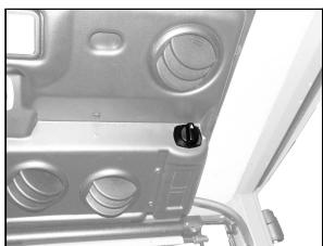
С помощью ручки можно регулировать температуру холодного воздуха. Вращая ручку, можно отрегулировать температуру. Вращая ее в направлении по часовой стрелке (вправо до упора) можно обеспечить максимальное охлаждение внутренней части кабины.
