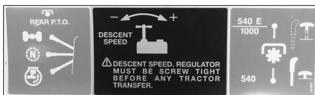
Ослабляя фиксатор, можно увеличивать скорость опускания подъемника.
