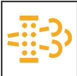
El operador debe desactivar la inhibición de la regeneración para permitir el inicio de la regeneración automática. Se realiza la solicitud para iniciar la regeneración automática; si la regeneración se pone en marcha, se enciende el indicador:
