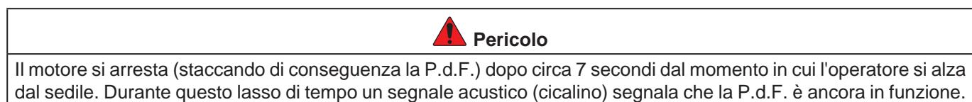
Per mantenere la P.d.F. in funzione anche quando l'operatore si alza dal sedile, occorre attivare la modalità "PTO Auto" premendo **2 volte entro 2 secondi** il pulsante (5) dopo l'inserimento della P.d.F.; sul display viene visualizzata l'icona (6). La modalità "PTO Auto" si disattiva una volta che l'operatore si risiede sul sedile.
