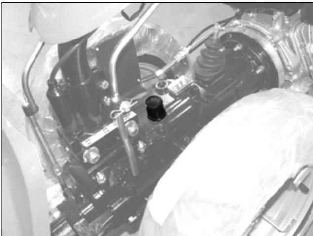
Controllare il livello dell'olio, tramite il tappo con asta graduata.
