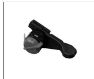
L'interruttore arresto motore si trova nella stegola destra attaccato al manettino acceleratore, è di colore rosso ed è possibile ruotarlo su una posizione ON di accensione del motore o due posizioni OFF di spegnimento del motore.
