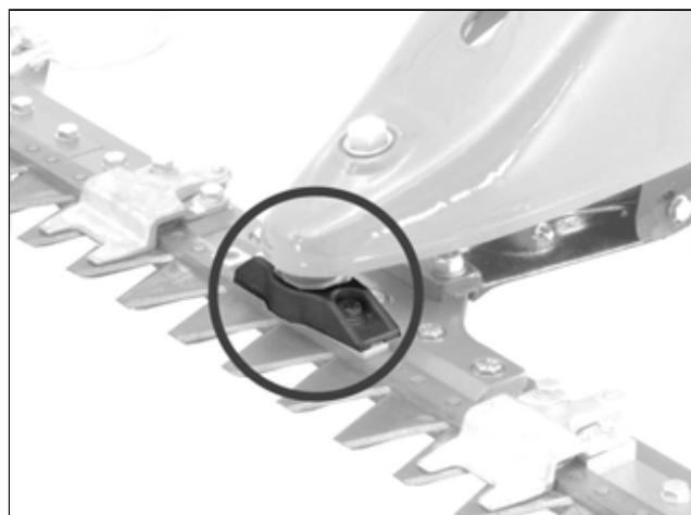
Togliere le viti che fissano la testa di lama e sfilare lateralmente la lama.
