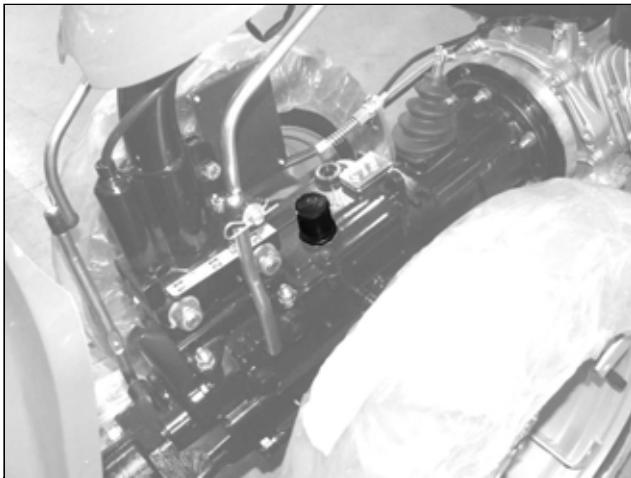
Den Ölstand mit dem Ölmessstab prüfen.
