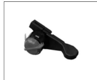
Der Motorabstellschalter befindet sich auf dem rechten Lenkholm in Verbindung mit dem Gashebel. Er hat eine rote Farbe und kann in die Stellung ON zum Starten des Motors und die Stellung OFF zum Abstellen desselben gedreht werden.
