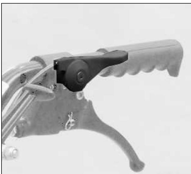
Der Handgaszug befindet sich vorn rechts im Traktor.
