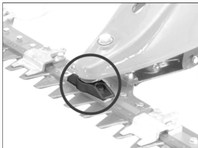
Quitar los tornillos que fijan el cabezal cuchilla y extraer lateralmente la cuchilla.
