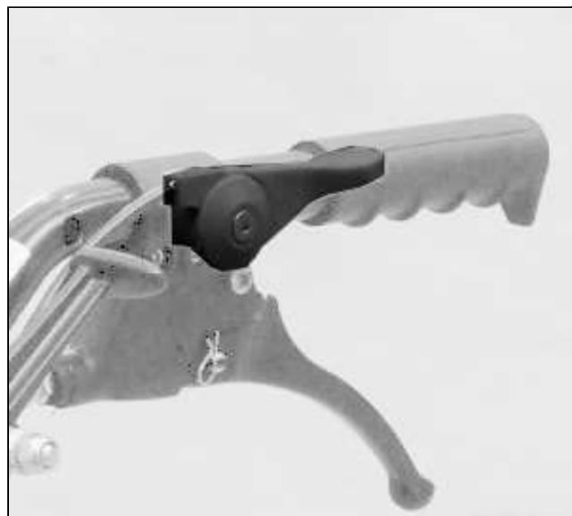
La palanca del acelerador de mano se halla en la zona delantera derecha del tractor.
