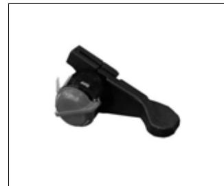
El interruptor de parada motor está ubicado en la manecera derecha, junto a la manecilla del acelerador, es de color rojo y es posible girarlo en una posición ON de encendido del motor o bien en dos posición OFF de apagado.
