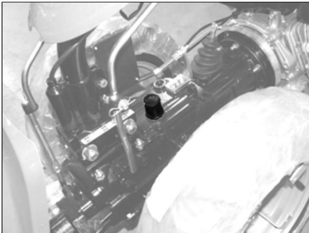
Controlar el nivel del aceite, mediante el tapón con varilla graduada.
