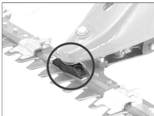
Tire os parafusos que fixam a cabeça de lâmina e desenfie lateralmente a lâmina.
