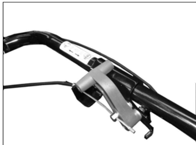
O tractor é dotado de bloqueio diferencial, de tipo mecânico, em ambos os eixos.
