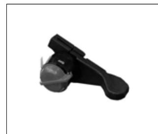
O interruptor de paragem do motor situa-se na rabiça direita, fixado na manete do acelerador, é vermelho e pode ser rodado para uma posição ON de ligação do motor ou para duas posições OFF de desactivação do motor.
