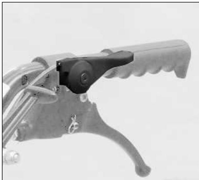
A alavanca do acelerador de mão situa-se na zona dianteira direita da máquina.
