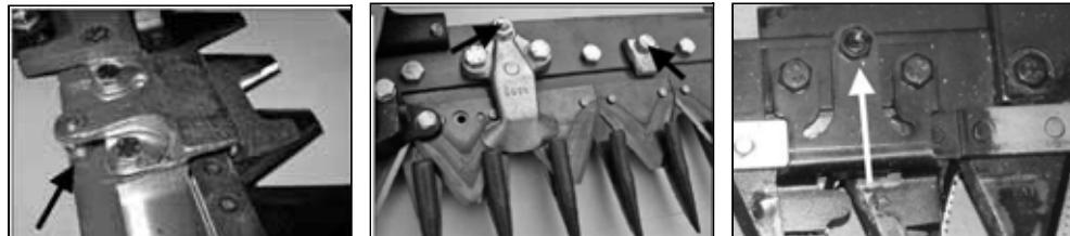
Mantenha a lâmina ajustada regulando adequadamente os respectivos retentores, que não devem ficar tão apertados a ponto de bloquear a lâmina nem permitir às mesmas uma folga excessiva em relação das placas de dentes. Para executar afinações nos retentores de lâmina, desaperte os parafusos de bloqueio e regule o parafuso de pressão. Quando os retentores de lâmina estiverem consumidos, é recomendável substituí-los, mesmo se ainda exercerem pressão.
