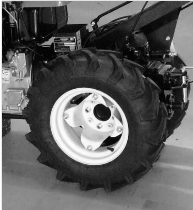
Possibilità di variare la carreggiata delle ruote spostando il disco ruota sulla flangia medesima.
