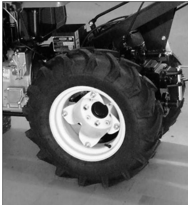
Possibilité de changer la voie des roues en déplaçant le disque roue sur la flasque elle-même.
