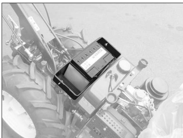
Per accedere alla batteria aprire il cofano e smontare la protezione togliendo i due pomelli laterali (figura 1)
