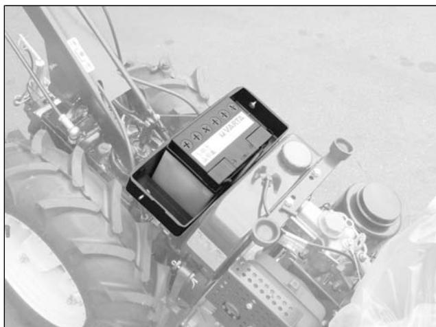
Pour accéder à la batterie ouvrir le capot moteur et supprimer la protection enlever les deux boutons latéraux (figure 1)
