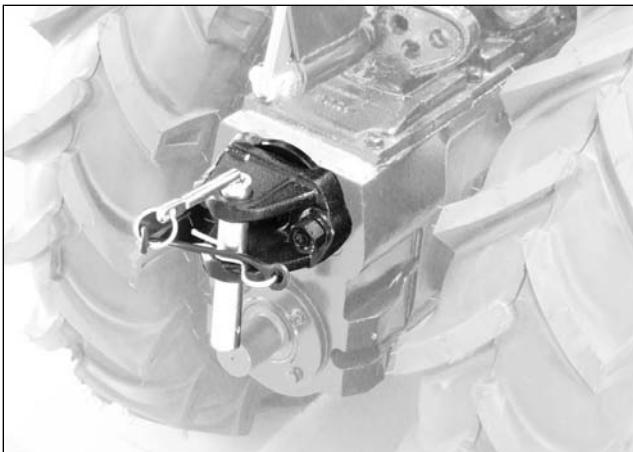
La machine peut être équipée d'un crochet d'attelage pour l'utilisation de petites remorques ou pulvérisateurs.
