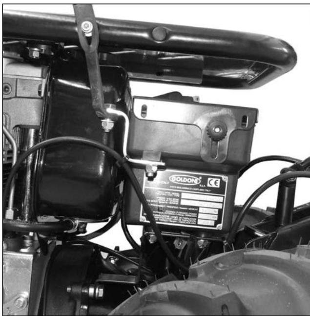
La plaque métallique est placée sur le couvercle de la boîte à accessoires.
