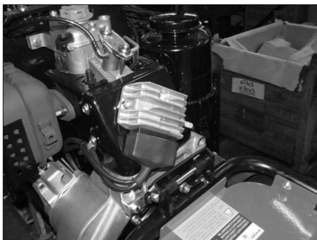
Pour le démarrage du moteur, il est conseillé de mettre la boîte de vitesses au point mort et la PDF en laissant le levier du Gear Stop ① soulevé, de manière à débrayer.
