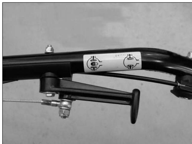
Le tracteur est doté d'un blocage de différentiel, de type mécanique, sur les deux essieux. L'utilisation est conseillée en cas de labour si une des deux roues motrices se trouve en conditions de faible adhérence (terrain boueux, accidenté, glissant).
