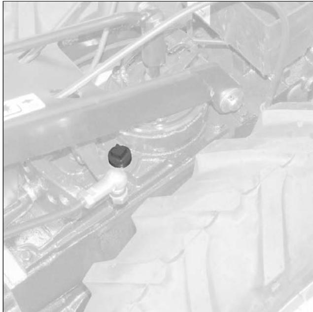
Controllare il livello dell'olio, tramite il tappo con asta graduata (MIN-MAX )
